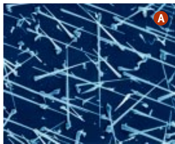
Figura 4. Em A, nanofios de fosfeto de índio (material semiconductor) crescidos pelo método vapor-líquido-sólido. Em B, fotografia em resolução atômica do nanofio. Observar a escala de comprimento de cinco nanômetros (barra inferior esquerda) e a grande ordem cristalina dos átomos no nanofio
