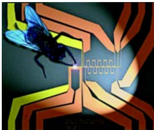
Figura 3. Possível esquema para um chip atômico: o ponto luminoso é um condensado de Bose-Einstein, mantido por campos magnéticos a uma distância de alguns microns da superfície do circuito integrado – a mosca dá uma idéia do grau de miniaturização
