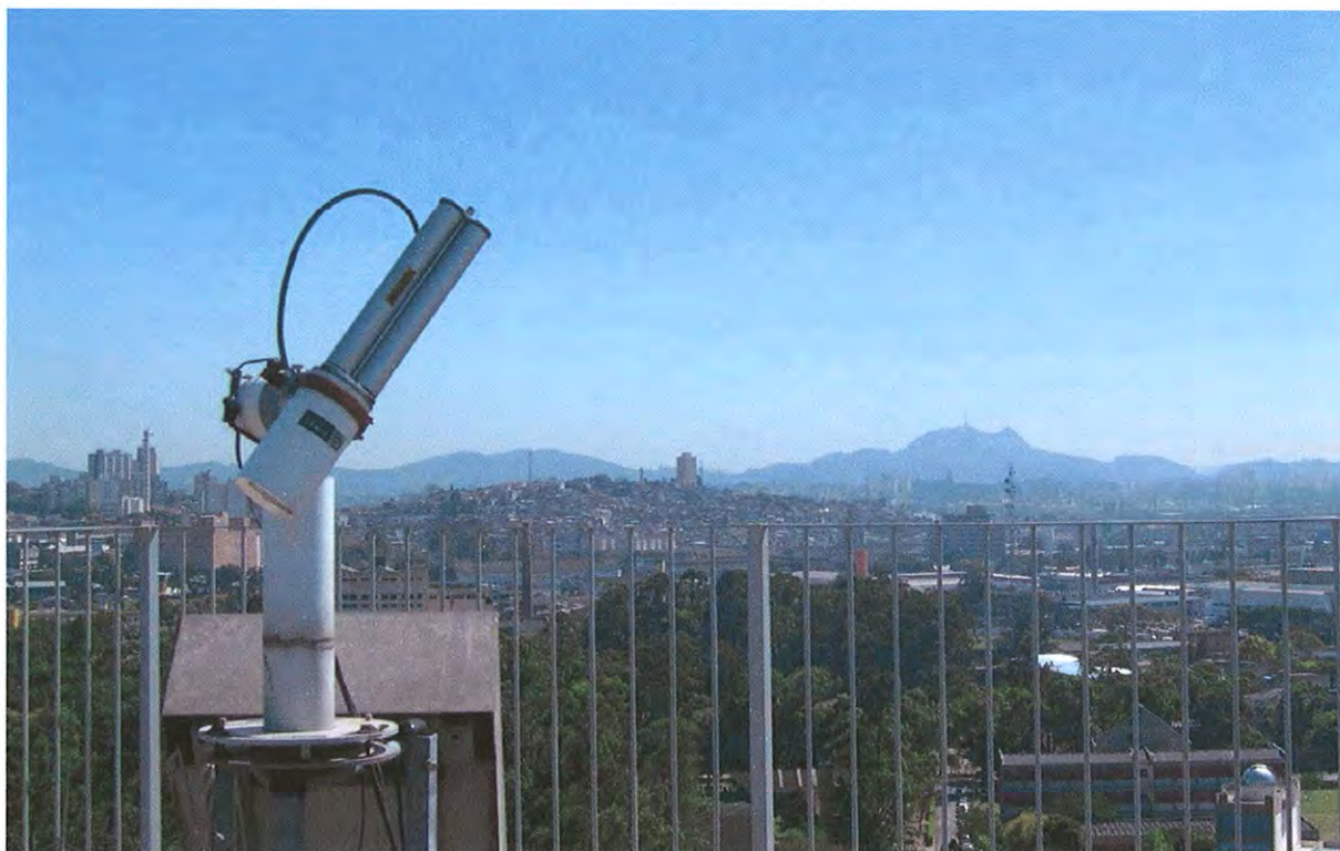
Figura IV-1: Foto do radiômetro CIMEL da rede AERONET em operação em São Paulo no Instituto de Física da USP.
