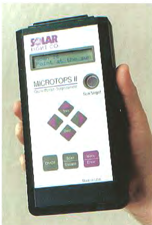
Figura IV-4: Foto ilustrativa do fotômetro solar MICROTOPS II, obtida do site do fabricante ( http://www.solar.com/manuals.htm ). http://www.solar.com/manuals.htm .
