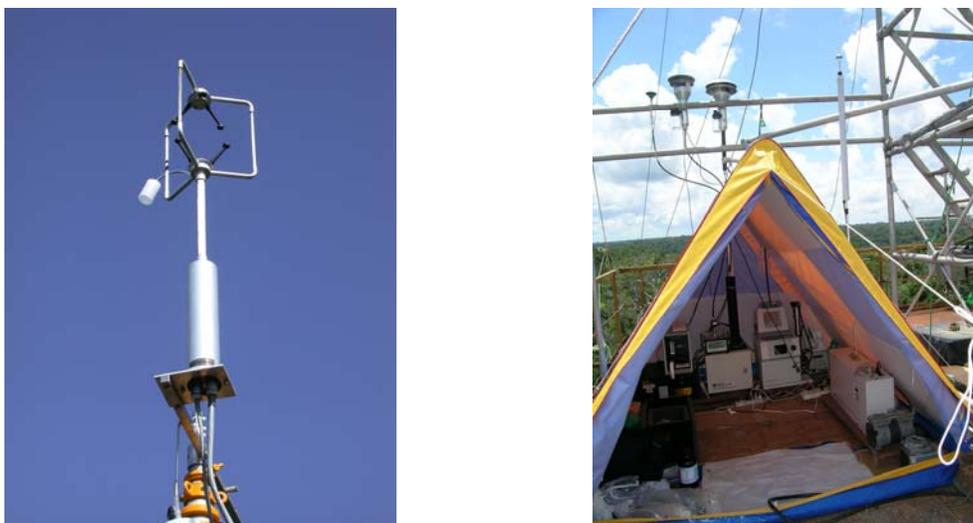
**Figura 4.1.3:** a) anemômetro sônico instalado a 54m de altura; b) instrumentos para medição de aerossóis instalados no nível Topo, a 40m de altura.
