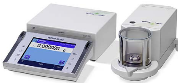
Figura 16 – Balança Ultramicroanalítica XP6U, da marca Mettler, utilizada nas medidas de massa nos filtros de policarbonato Nuclepore.
