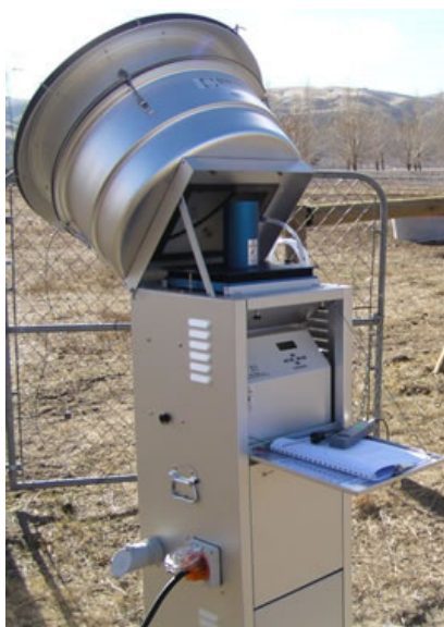
Figura 15 – Esquema do amostrador de particulado de alto volume (HiVol – 3000) . Fonte: (Ecotech Pty Ltd., 2013).
