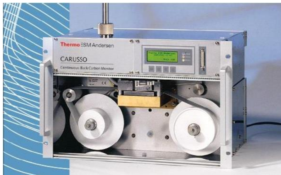
Figura 15 – MAAP ( Multi Angle Absorption Photometer ), utilizado para medir o black carbon equivalente através da atenuação de um feixe de luz (670 nm) em um filtro de partículas.
