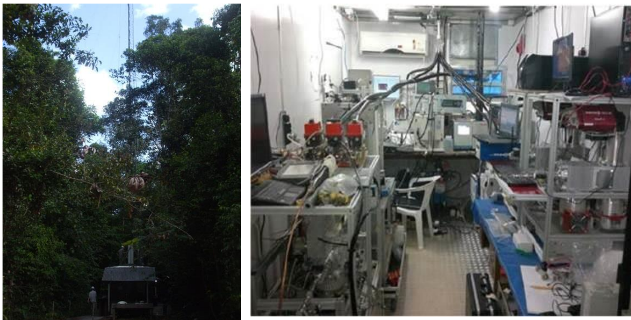
Figura 8 - Contêiner utilizado como plataforma de amostragem de aerossóis e gases na base da torre TT34 (esquerda) e arranjo experimental dos diferentes instrumentos dentro do contêiner (direita).
