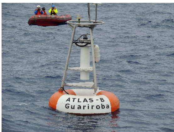
Figura A4b.2: Primeira boia Atlas-B (“Guariroba”) imediatamente após o bem sucedido fundeio, na posição 28.5o S, 44.0o W. Essa bóia foi ancorada em uma região com aproximaamente 4 mil metros de profundidade e está equipada com vários sensores para o monitoramento de variáveis na interface ar-mar (temperatura do ar, intensidade e direção do vento, umidade relativa, precipitação e fluxos radiativos e termodinâmicos) e na coluna de água (temperatura e salinidade nos primeiros 500 metros e no fundo).
